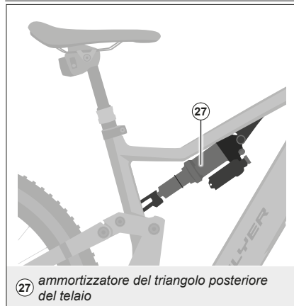
Fig. 22: ammortizzatore del triangolo posteriore del telaio
