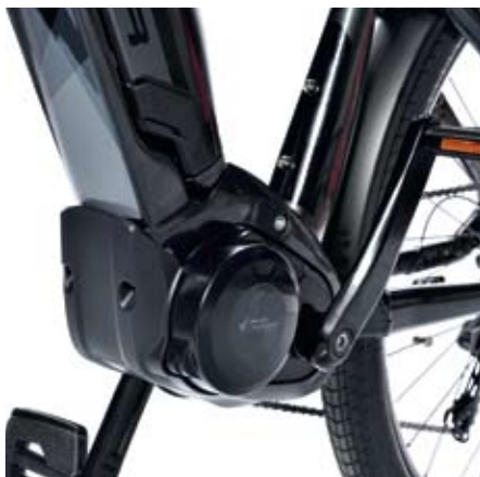
Der neue Panasonic Mittelmotor mit zwei-stufigem Getriebe.
